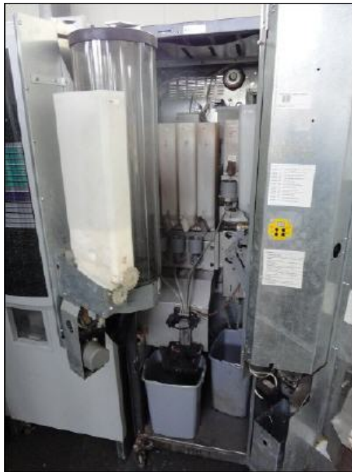
Obr. 13. Omnimatic Lotus, vlevo – vnitřní uspořádání, vlastní zpracování
