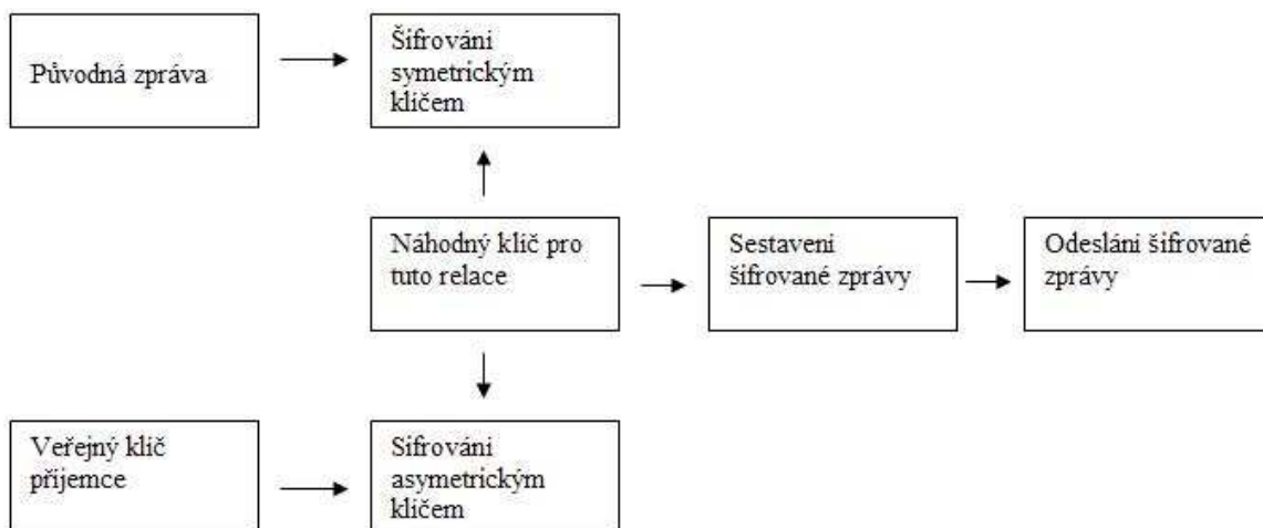
Obr. 26. postup šifrování komunikace s programem PGP
