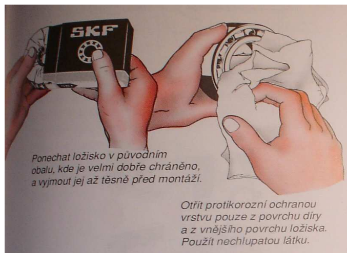
Obr. 9. Ložisko těsně před montáží
