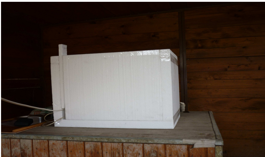
Obr. 6 Uzavřený tepelně izolační box pro odběry v zimních měsících
