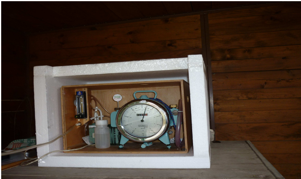
Obr. 5 Vyrobený tepelně izolační box s odběrovou aparaturou
