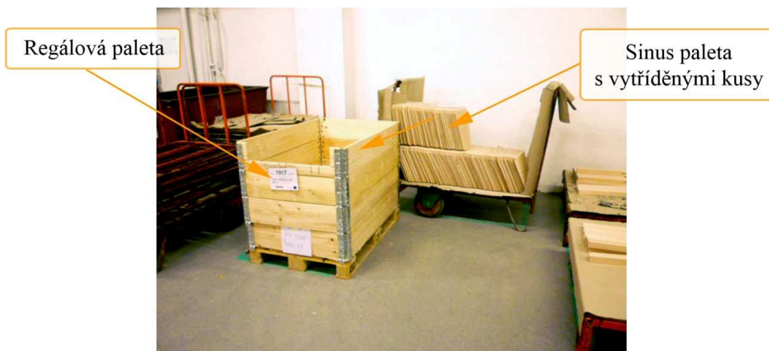
Obr. 27. Pracoviště přeskládávání – signál pro pracovníci k zahájení činnosti přeskládání
