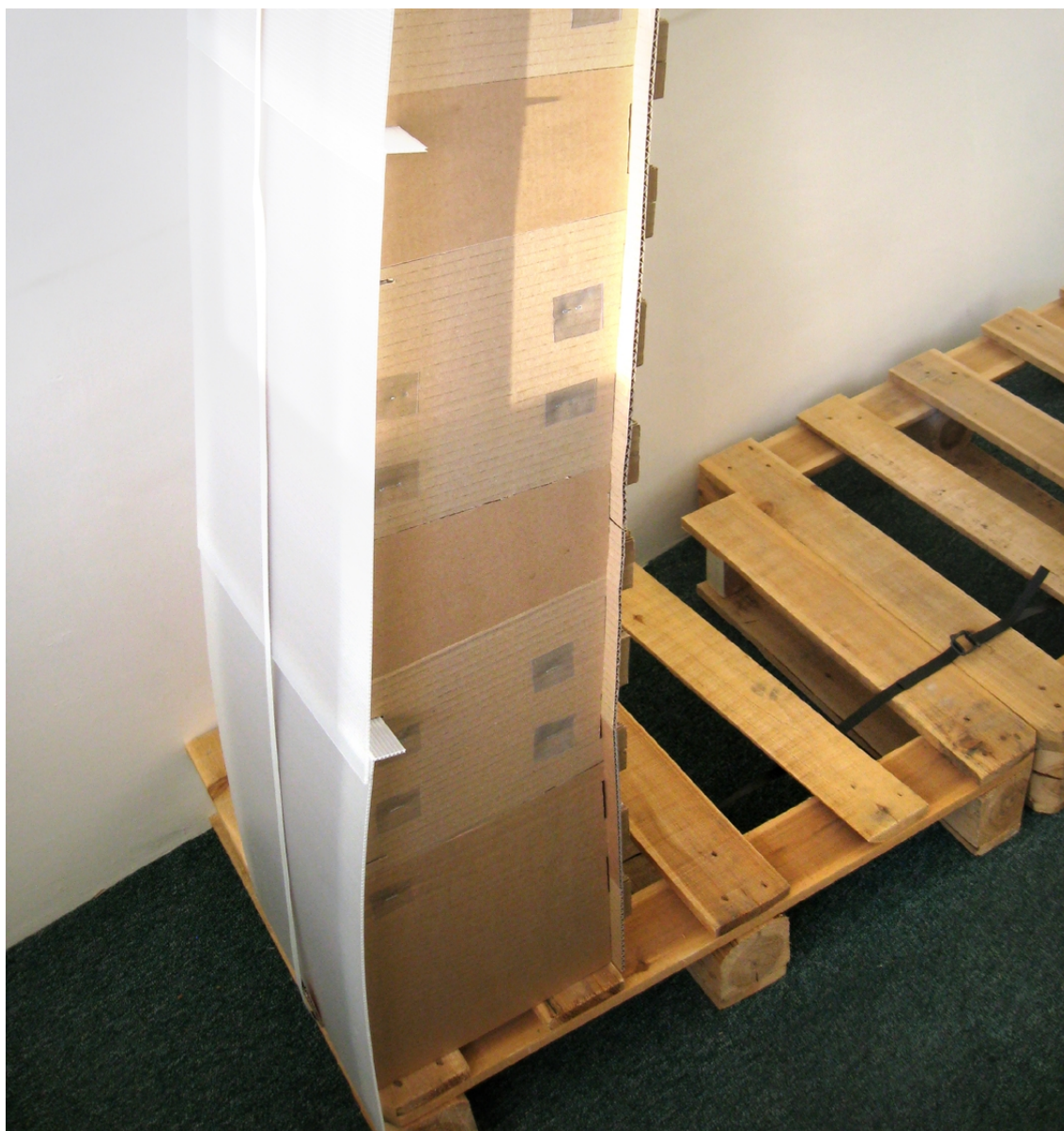
Obr. 36. provázání oblouků a EURO-palet vázací páskou a sponami
