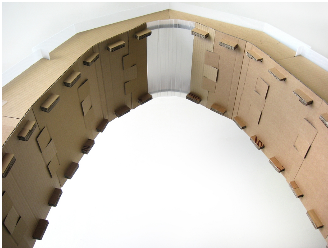
Obr. 35. detail spoje pláště s obloukem a horní přívod světla
