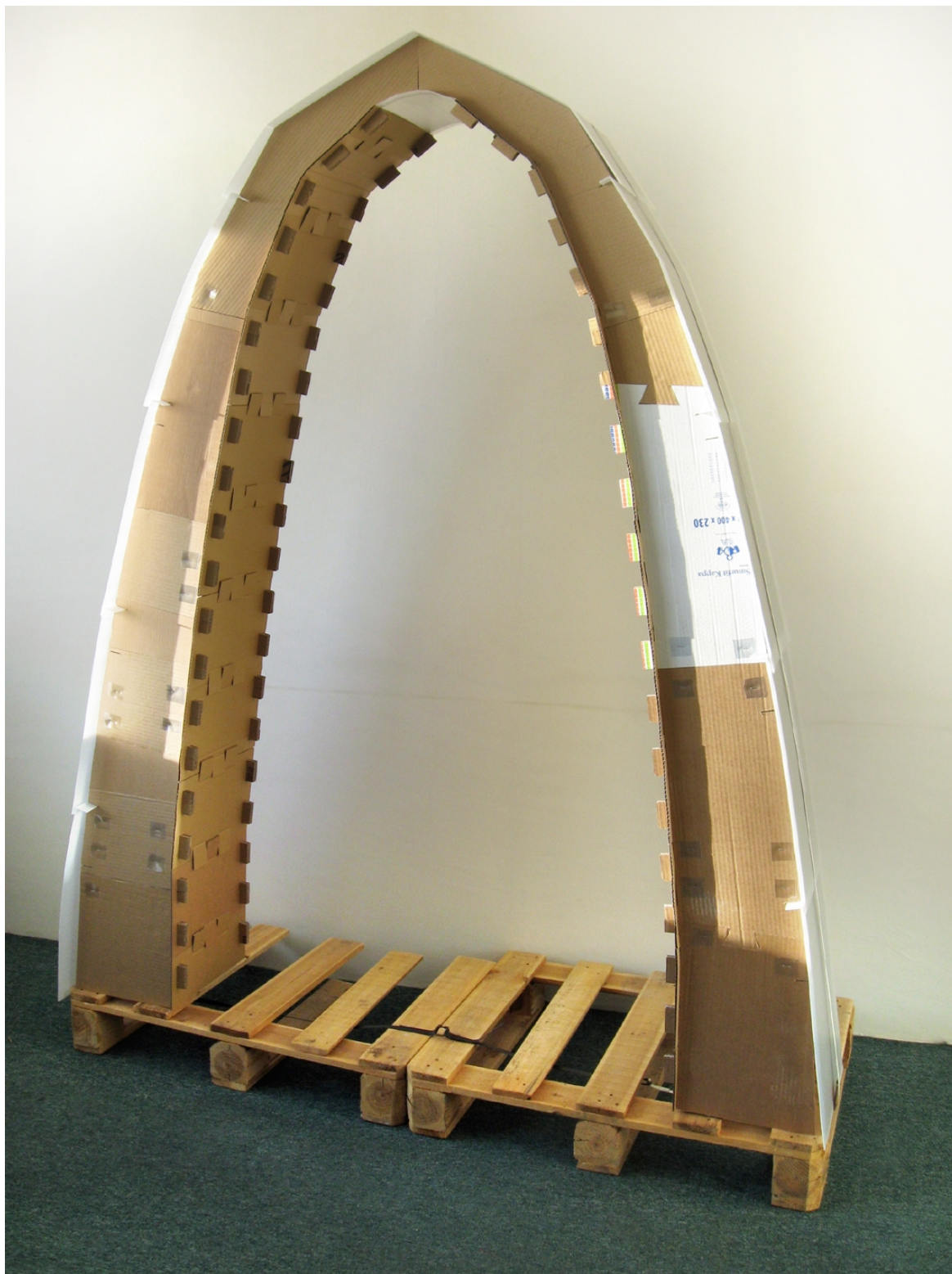
Obr. 32. oblouk jako jeden z devíti modulů přístřeší
