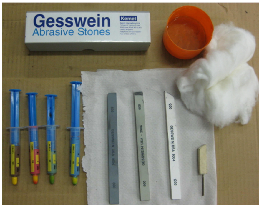
Obr. 48. Použité nástroje při ručním leštění (lapování)
