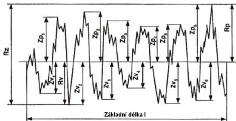
Obr. 12. Amplitudové parametry – R_p , R_v , R_z [19]
