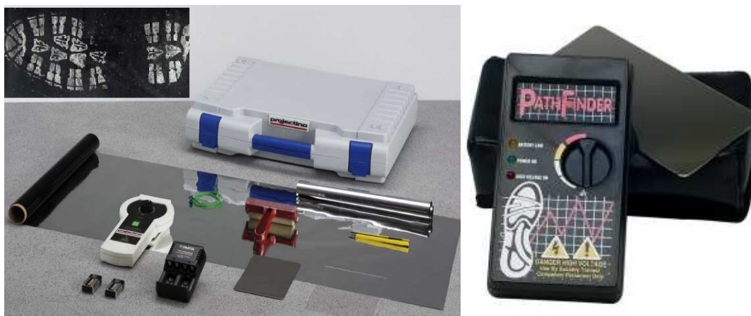
Obr. 14. Dustprint lifter a PathFinder pre elektrostatické snímanie stôp.
