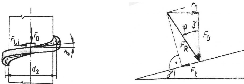
Obr. 12 Silové poměry na šroubu
