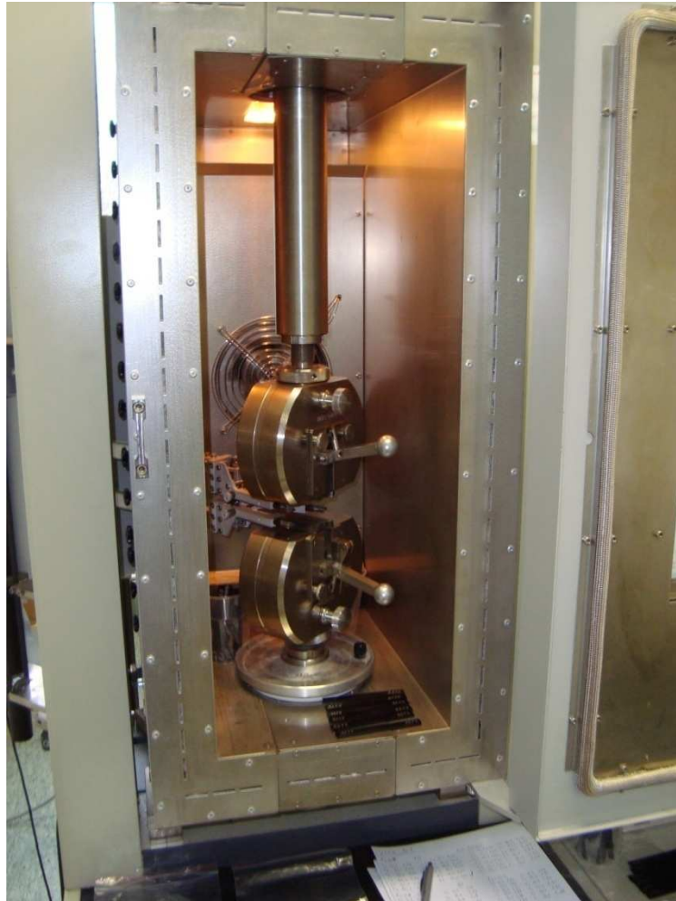
Obr. 24 Vnitřní prostor temperační komory s čelistmi pro tahovou zkoušku
