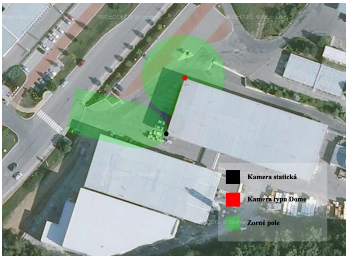
Obr. 25 Návrh kamerového systému provozu nad cestou
