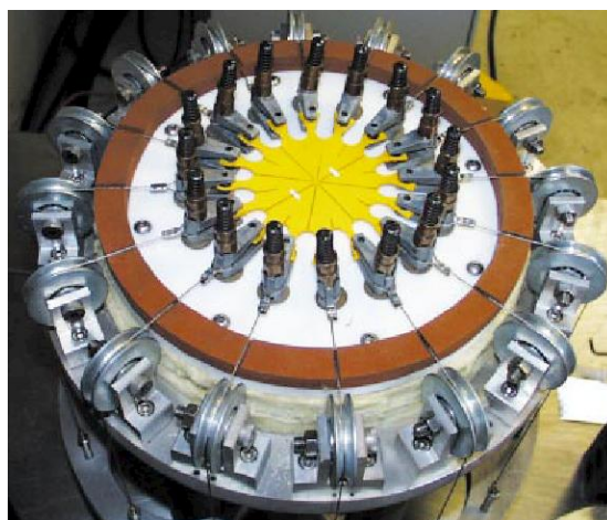
Obr. 11 Metoda dvouosého tahu pomocí radiálního tahu [9]
