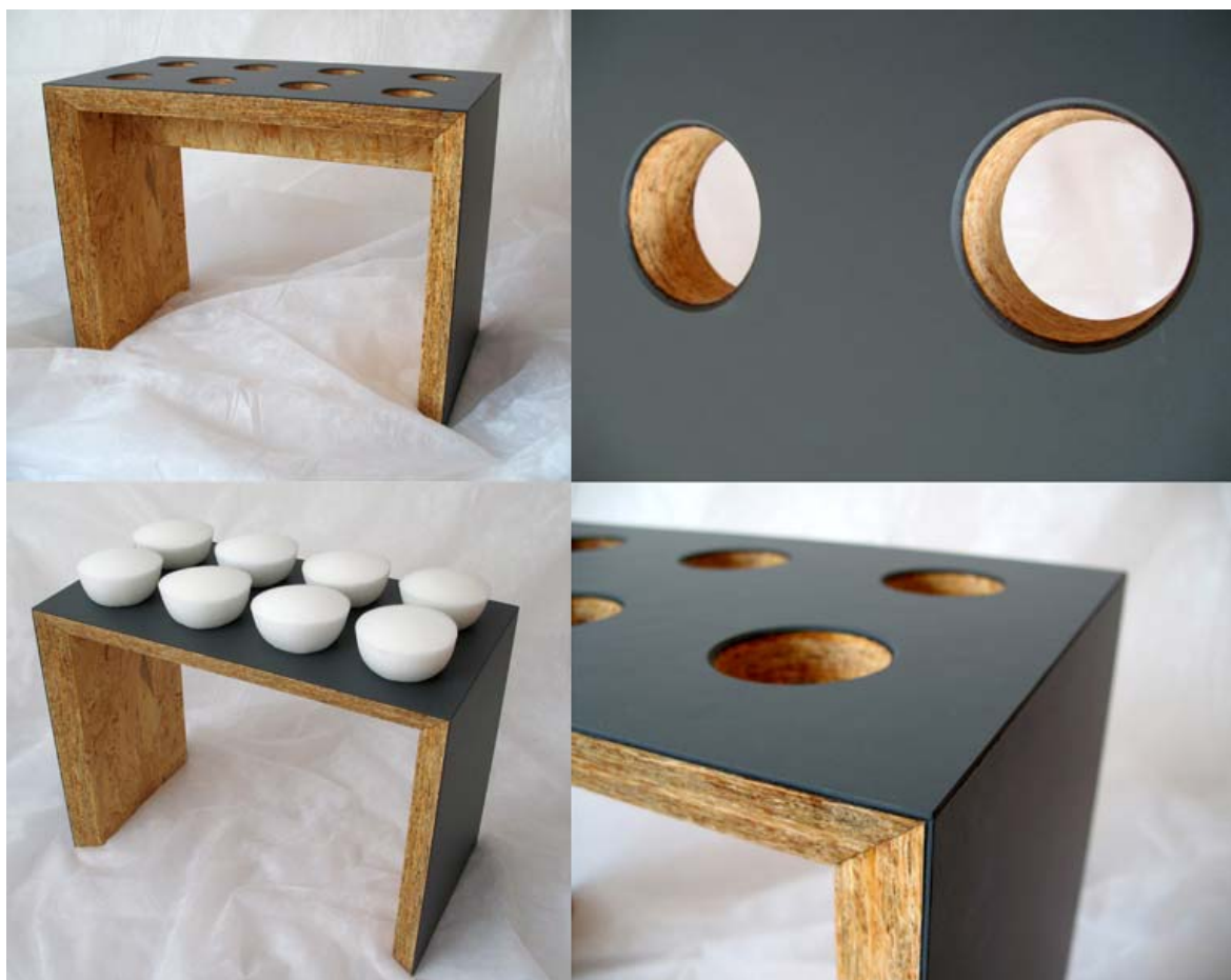
Obr. 65. Fotografie modelu stoličky: povrchová úprava nábytkovým linoleem a lněnou fermeží
