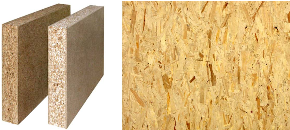
Obr. 2. Struktura třívrstvé DTD a struktura OSB
