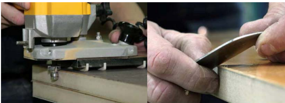
Obr. 19. Manuální úprava hran
