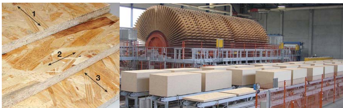
Obr. 8. Směrové uspořádání vrstev OSB a pohled na výrobní proces
