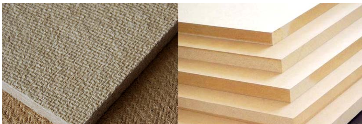
Obr. 3. Struktura SOLOLITU a MDF
