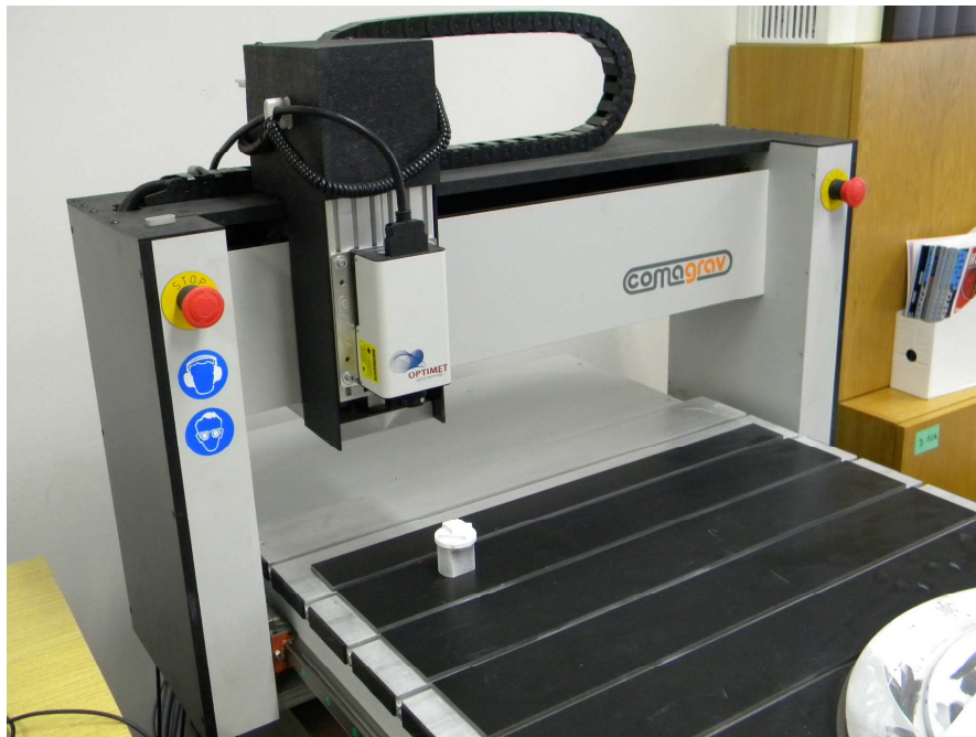
Obr. 33 Zariadenie pre laserové skenovanie
