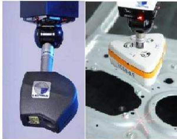
Obr. 22 Laserové hlavy pre CNC stroje skenujúce v jednej a troch rovinách
