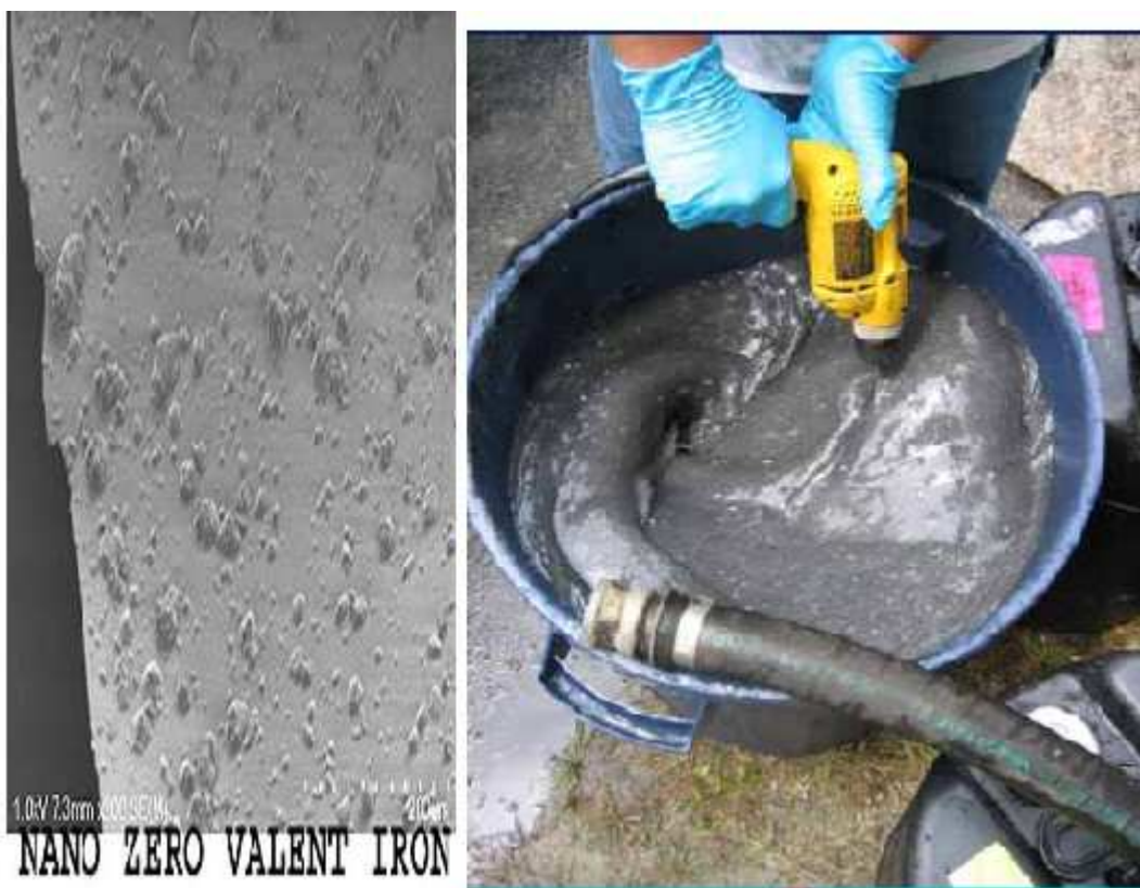
Obr. 11. nZVI pod mikroskopem, příprava nZVI před vypuštěním do podzemní vody [28].
