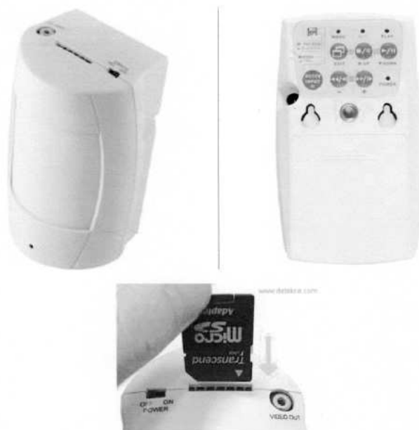
Obr. 22. Maskovanie kamery za PIR senzor
