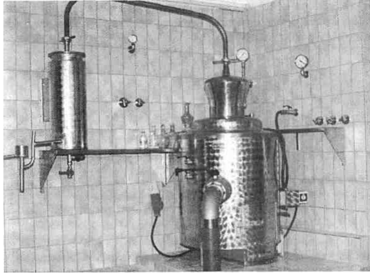
Obr.č.8 : Kotel s elektrickým ohřevem
