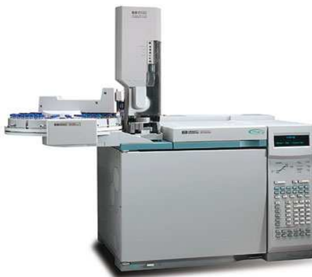
Obrázek č.17: Plynový chromatograf HP 6890 Series GC
