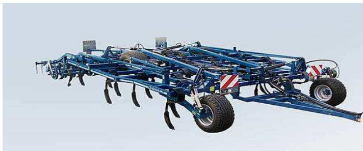
Obr. 22 Exaktní kypřič Köckerling Vario 4,80 [14]
