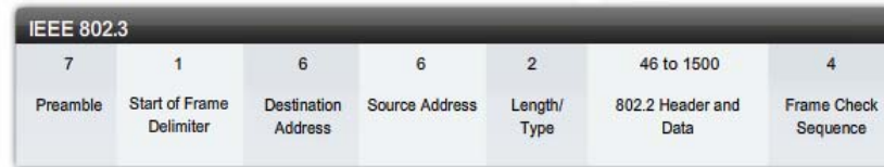
Obr. 3. Štruktúra IEEE 802.3 rámca
