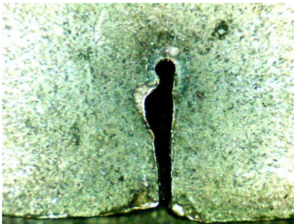
Obr. 39. Výstup laseru z materiálu v místě náběhu s viditelným odstříkem roztaveného materiálu
