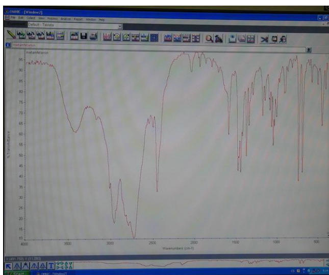
Obr. 27. Naměřené spektrum Metamfetaminu
