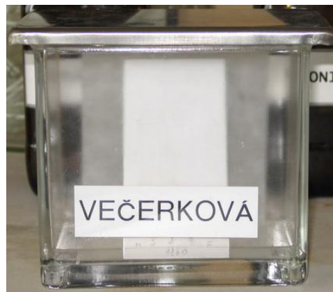
Obr. 9. Vyvíjecí nádoba s kapalinou
