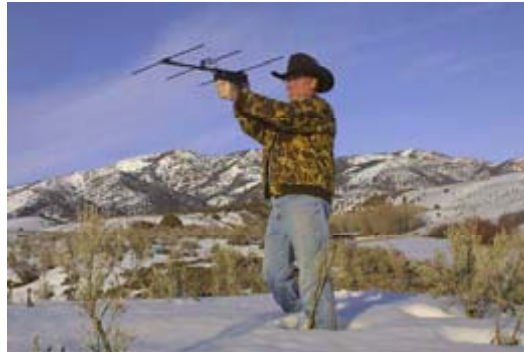
Obr. 6: Polarizace přijímací antény - pták na zemi (Zdroj: [8])
