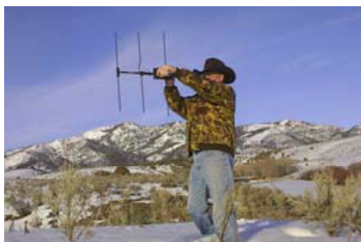
Obr. 5: Polarizace přijímací antény - pták na bidle (Zdroj: [8])
