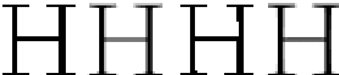
Obr. 11: zvětšená verzálka H z písma Quodlibet News Thin před hintingem vykreslená pro velikost 48 b zleva rasterizery Adobe BW , Adobe Grayscale , FreeType BW a FreeType Grayscale
