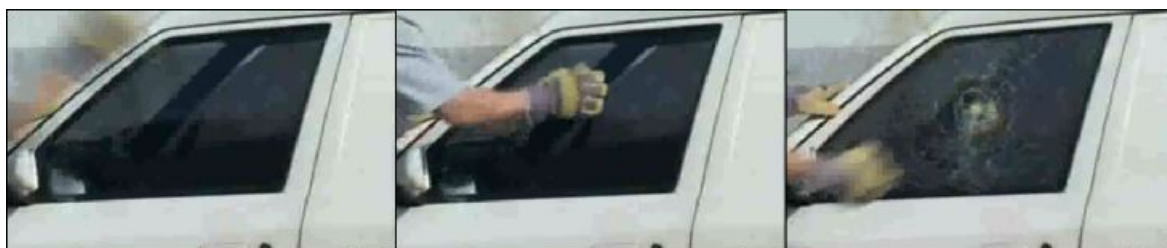
Obr. 3. Pokus o rozbití autoskla vybaveno bezpečnostní fólií
