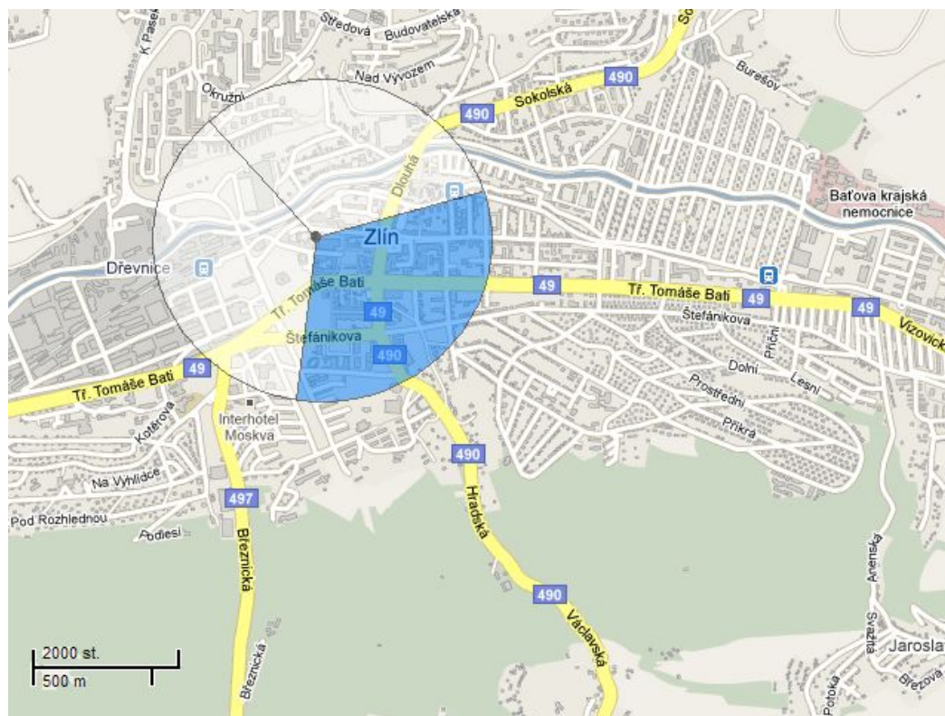
Obr. 9. Rozdělení a určení sektorů BTS stanice
