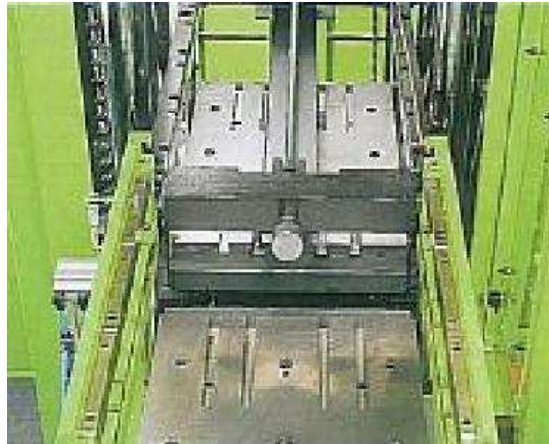
Obr. 23. Vysouvání rámu formy
