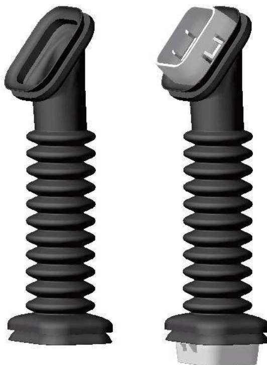
Obr. 14. CAD modely pryžového výstřiku a konečného dílu
