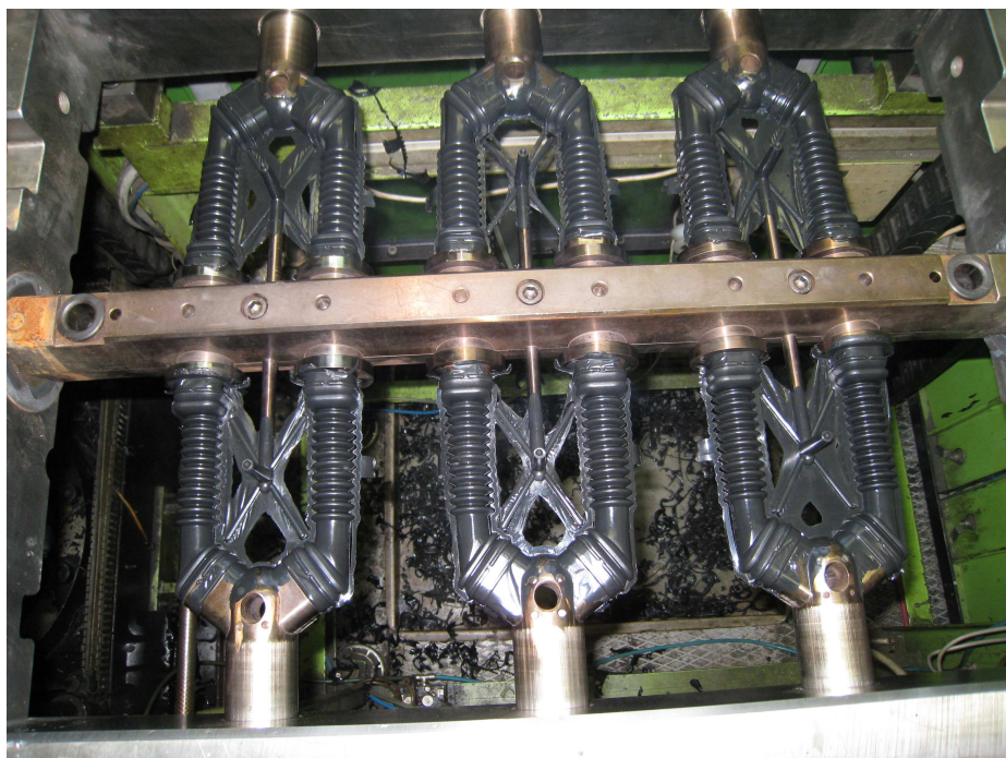
Obr. 35. Rám formy v sériové produkci před odformováním
