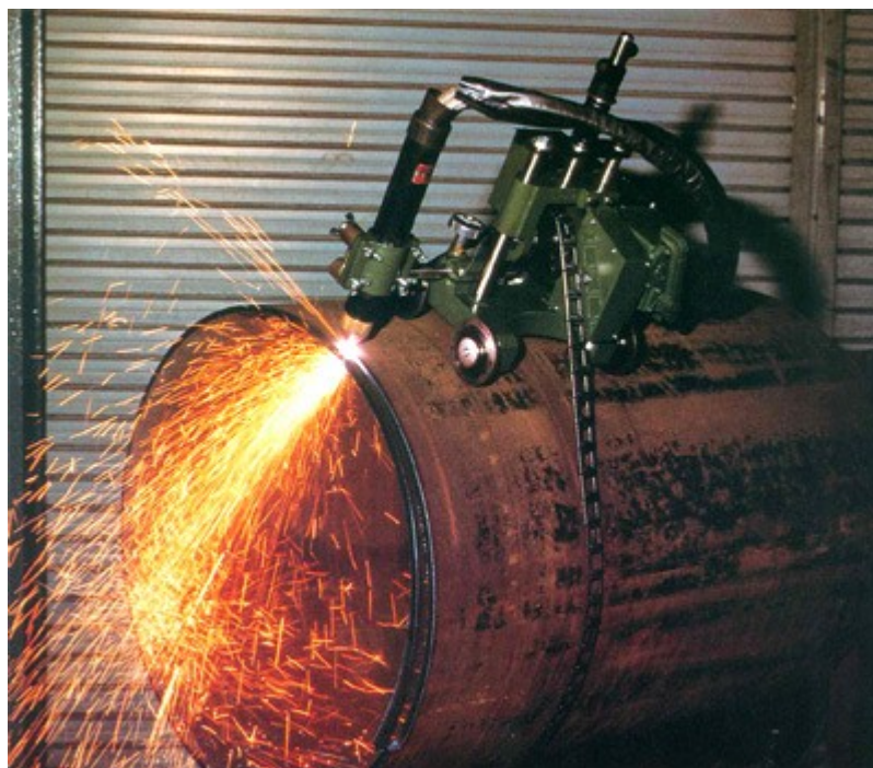
Obr. č. 12 Motorizovaný plazmový řezací stroj na řezání rour
