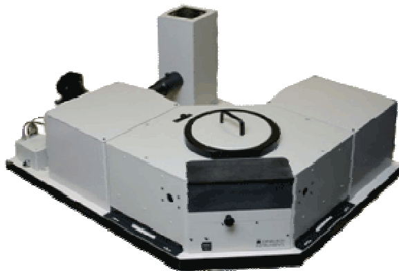
Obrázek 10 Použitý flourimetr FLS 920 P.
