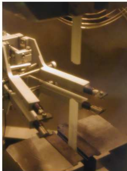
Obr. 51 Měření zkoušky tahu vně temperanční komory
