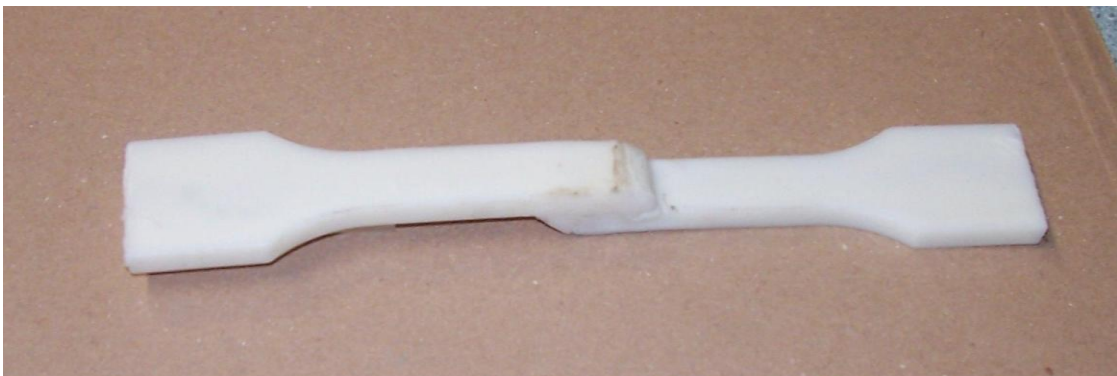
Obr. 26. Zkušební těleso – přeplátovaný svar, materiál ABS
