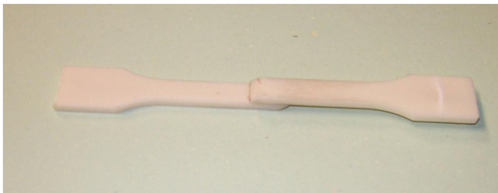
Obr. 24. Zkosení lopatek pro přeplátovaný svar
