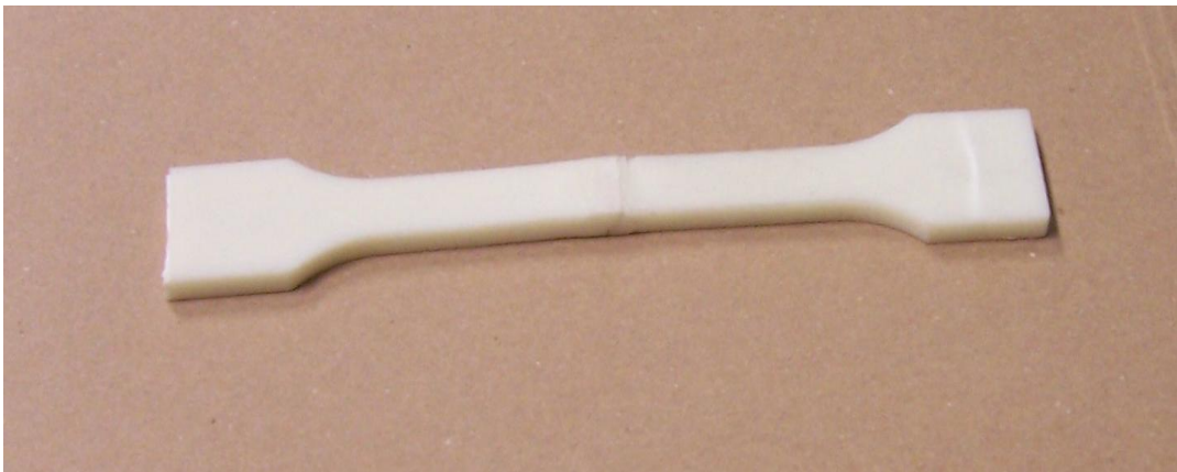
Obr. 25. Zkušební těleso – svar X, materiál ABS
