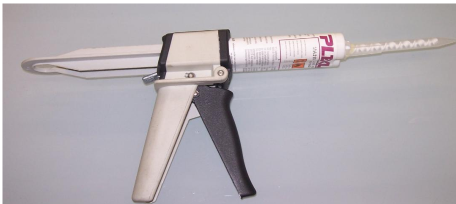
Obr. 30. Vytlačovací pistole a statický mixer
