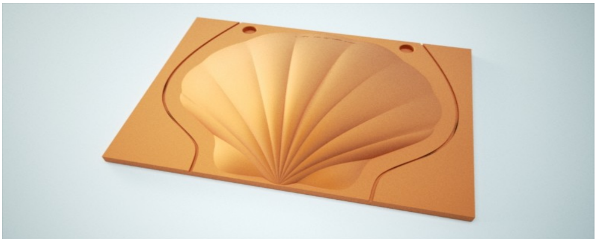
Obr. 38. Forma pro Vakuové formování – výroba obalu
