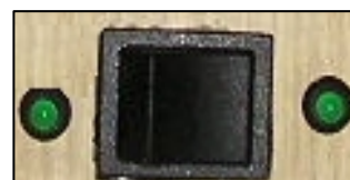
Obr. č. 32 – Pohled na přepínač režimů ventilátoru
