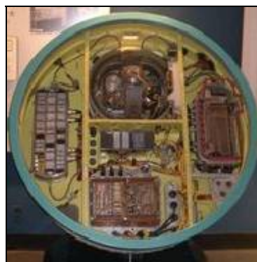
Obr. č. 6 – Odkrytý korpus nukleární střely Minuteman I s pohledem na řídicí elek- troniku
