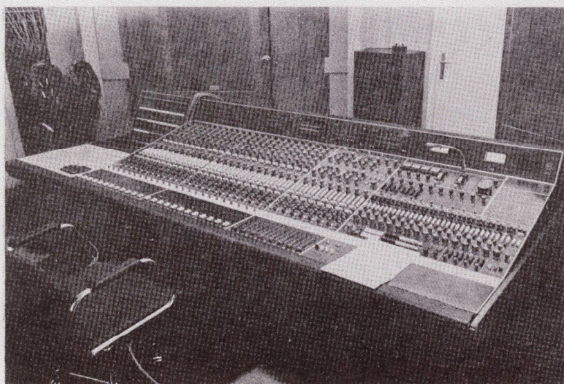
Nahrávací studio Supraphonu: srdce nahrávacího zařízení — směšovací stůl s 24 mikrofonními nebo linkovými vstupy, 8 výstupními skupinami a se šestnáctikanálovým monitorovým polem.
