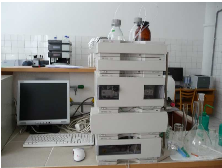
Obr. 14: Chromatograf HPLC na kterém byla provedena analýza
