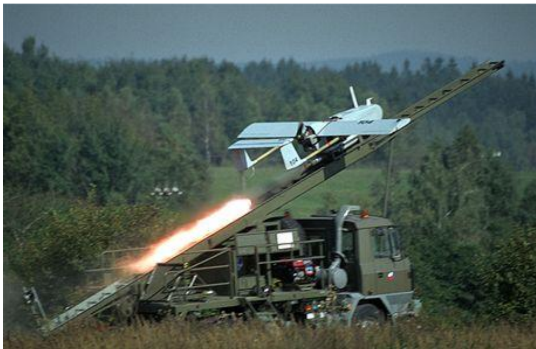
Obr. 3. Bezpilotní letoun Sojka III při startu pomocí startovací rampy
