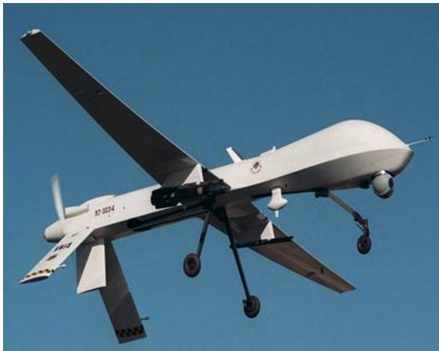
Obr. 5. Bezpilotní letoun predátor, kde je vidět senzorická hlava
