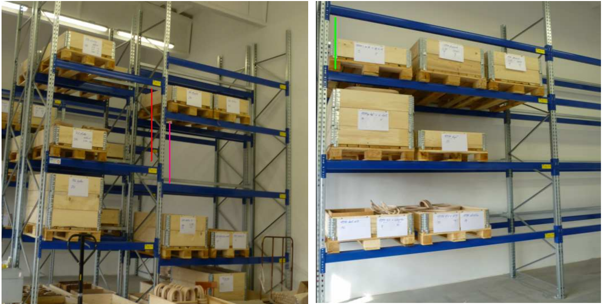
Obr. 32 a,b Rôzne výškové nastavenie nosníkov v regále [vlastné spracovanie]
