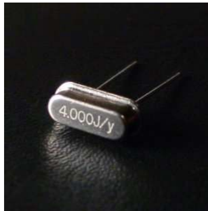
Obr. 6. Miniaturný 4MHz kremenný kryštál v hermetickom obale využívaný ako rezonátor v kryštalickom oscilátore [12]
