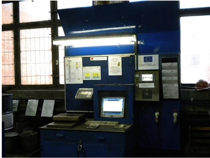
Obrázek 15 – Pracoviště pro online měření hmotnosti
