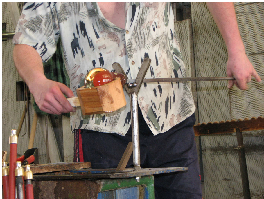
Obrázek 3: Vytvarování baňky ve svaláku.
